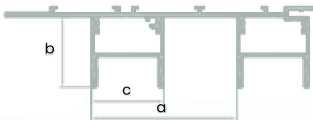
PARALLINE FIN SE COMPOSE D'UN PROFILÉ EN U VERTICAL EN ALUMINIUM D'UNE PROFONDEUR ET D'UNE LARGEUR APPARENTE DE 35MM. AVEC SON PROFILÉ EN U, LA VARIANTE DE DESIGN VERTICALE FIN PRÉSENTE L'ASPECT LE PLUS MINIMALISTE.
