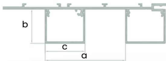
PARALLINE MID SE COMPOSE D'UN PROFILÉ BLOC VERTICAL EN ALUMINIUM D'UNE PROFONDEUR DE 30MM.
