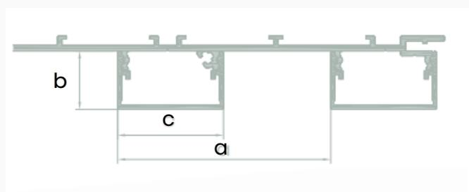
PARRALINE LOW SE COMPOSE D'UN PROFILÉ BLOC VERTICAL EN ALUMINIUM D'UNE PROFONDEUR DE 20MM.
