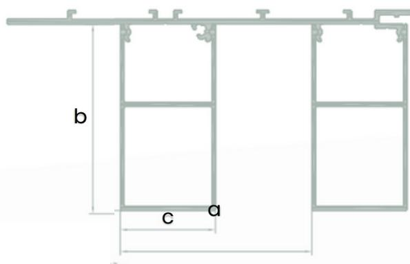
PARALLINE HIGH SE COMPOSE D'UN PROFILÉ BLOC VERTICAL EN ALUMINIUM D'UNE PROFONDEUR DE 70MM.
